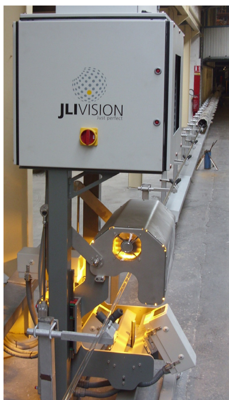
Типичная установка системы онлайн-контроля JLI vision (SK-3020 слева, SK-4020, SK-3020D справа).
