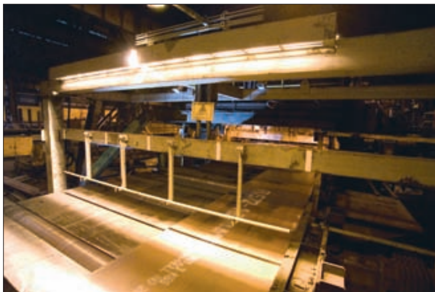
Visionsystem til måling af planhed af jernplader.
